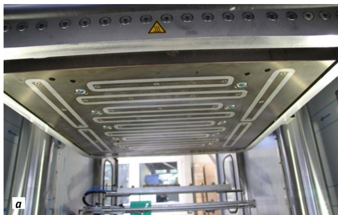
Фото 1. Верхняя, неподвижно закрепленная магнитная плита (а) и нижняя магнитная крепежная плита, которая должна выдвигаться из зоны прессования вместе с нижней полуформой (не показана на фото) для размещения в ее гнездах закладных элементов (б) (все фото: Wickert Maschinenbau GmbH)
