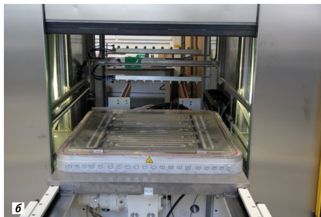
Фото 2. По роликовым планкам, расположенным в пазах нижней магнитной плиты (а), эта плита вместе с закрепленной на ней сменной пресс-формой (не показана на фото) может быть легко задвинута в рабочее положение (б)
