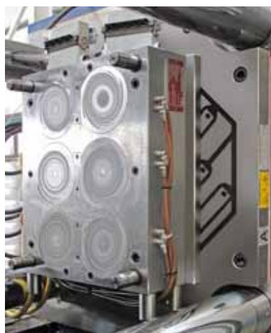
Фото 2. Системы магнитного крепления M-TECS 130 предназначены для использования при температурах до 130 °С
