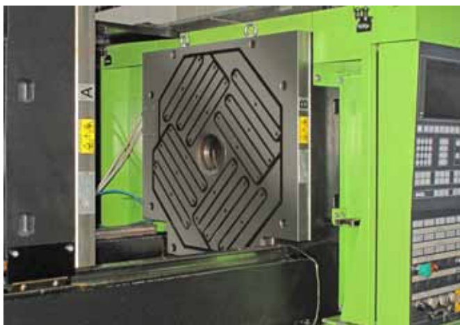
Фото 3. Уже 22 из 42 имеющихся на предприятиях Palaplast литьевых машин оснащены системами магнитного крепления форм M-TEC 130
