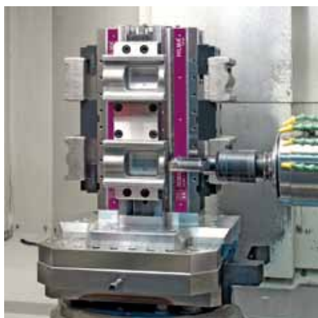
Зажимная система башенного типа TS 125 с функцией 3-й руки
