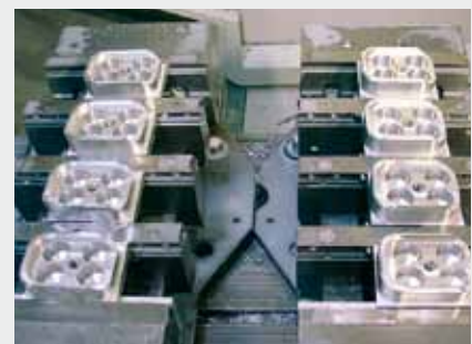
Зажимная кромка снимается фрезой на 2-й ступени зажима.
