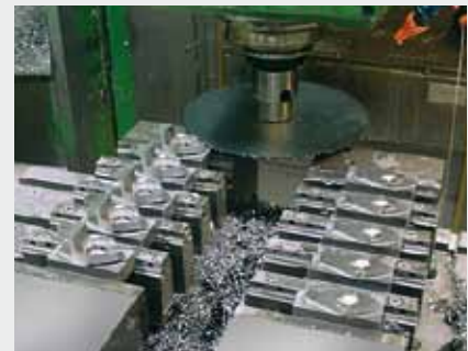
После чистовой обработки "прибыль" отделяется от детали при помощи дисковой фрезы.
