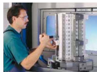
3. Зажимной модуль закрепляется при помощи эксцентрикового винта и динамометрического ключа.
