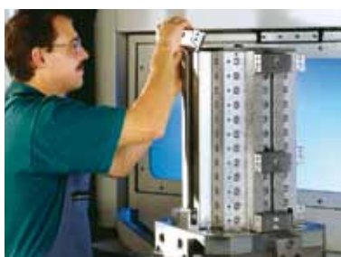
1. Зажимной модуль с открытым эксцентриковым затвором помещается в высокоточный паз.
