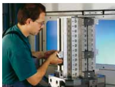
2. Зажимной модуль точно позиционируется на базовом при помощи градуировки и шкалы.
